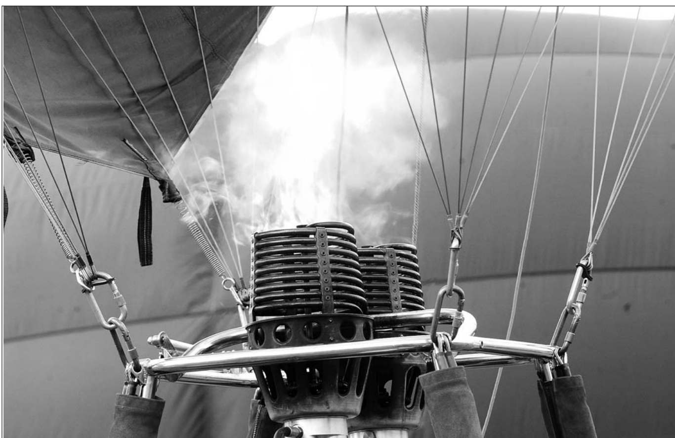
Mächtige Gasbrenner erwärmen die Luft in der Ballonhülle.
